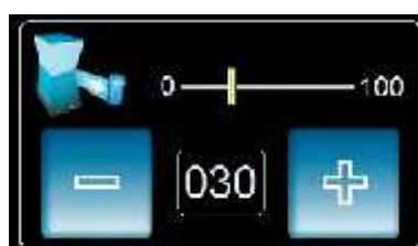
Impostazione della forza di deposito del film sul prodotto Setting of film deposit strength on product
