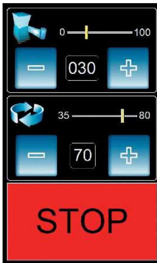
Impostazione della forza di deposito del film sul prodotto Setting of film deposit strength on product
